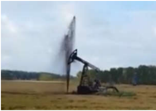
Рисунок 1 – Фонтанування свердловини в результаті ГНВП
