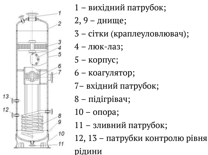
Рисунок 1 – Типова схема газового вертикального сіткового сепаратора
