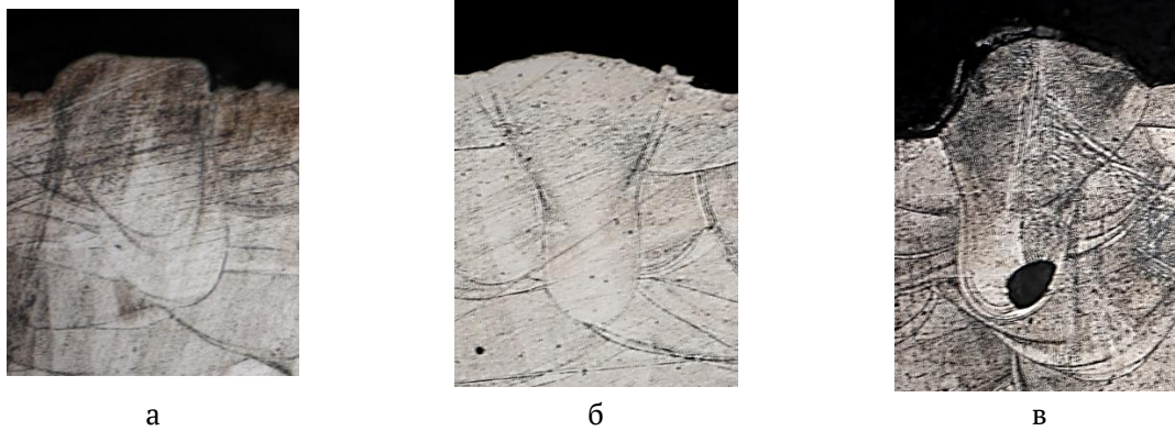
Рисунок 1 – Мікроструктури треків з близьким значенням глибини до ширини ванни розплаву \approx 1 , \times 200 : а – Р 270 Вт, V 800 мм/с, лінійна щільність енергії 76,39 Дж/мм 2 ; б – Р 110 Вт, V 400 мм/с, лінійна щільність енергії 62,25 Дж/мм 2 ; в – Р 150 Вт, V 400 мм/с, лінійна щільність енергії 84,88 Дж/мм 2
