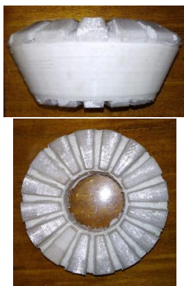
Рисунок 4 – Виготовлена модель ущільнювача превентора
