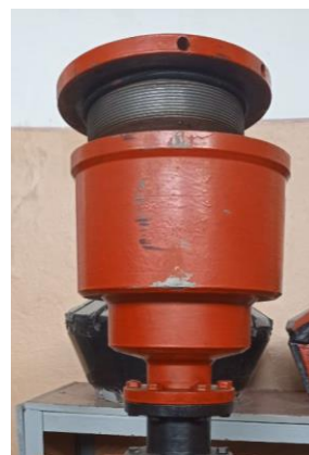
Рисунок 5 – Установка для дослідження конструкції ущільнювачів універсальних превенторів
