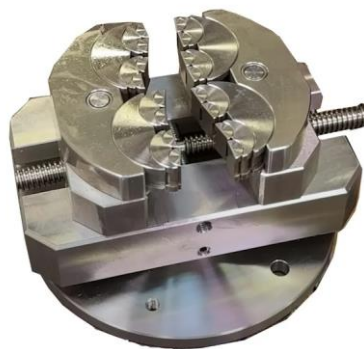
Рисунок 2 - Промислові фрактальні лещата з нержавіючої сталі
