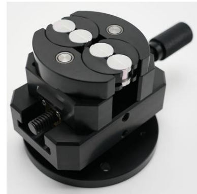
Рисунок 3 - Любительські фрактальні лещата з алюмінієвого сплаву
