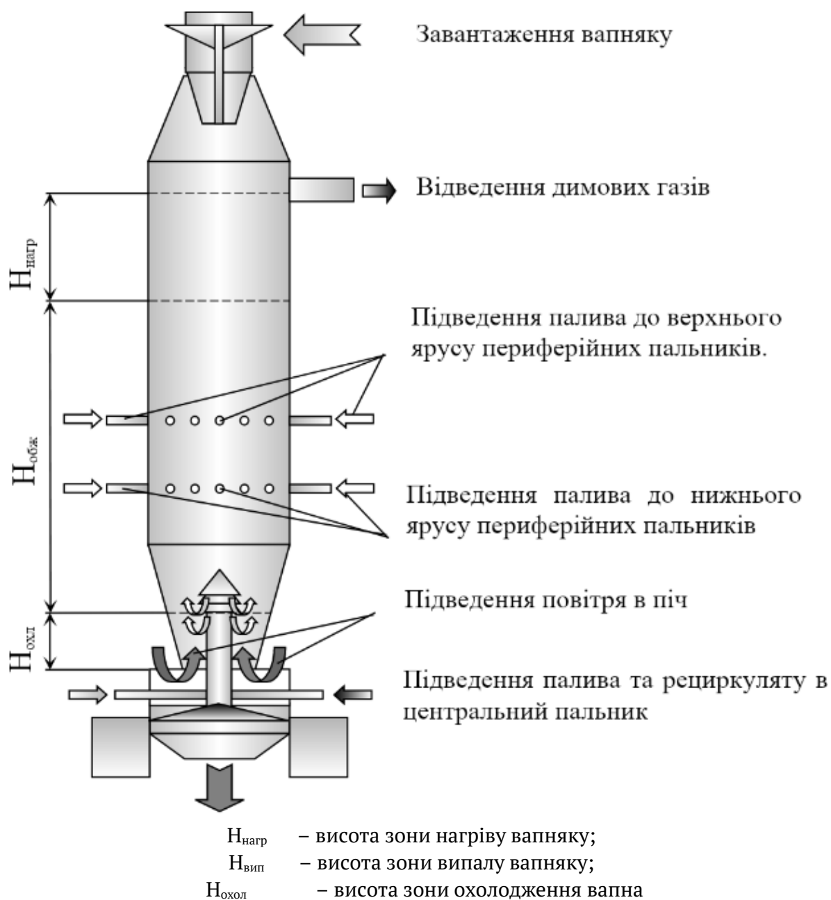
Рисунок 1 - Схема шахтної вапняно-випалювальної печі на газоподібному паливі
